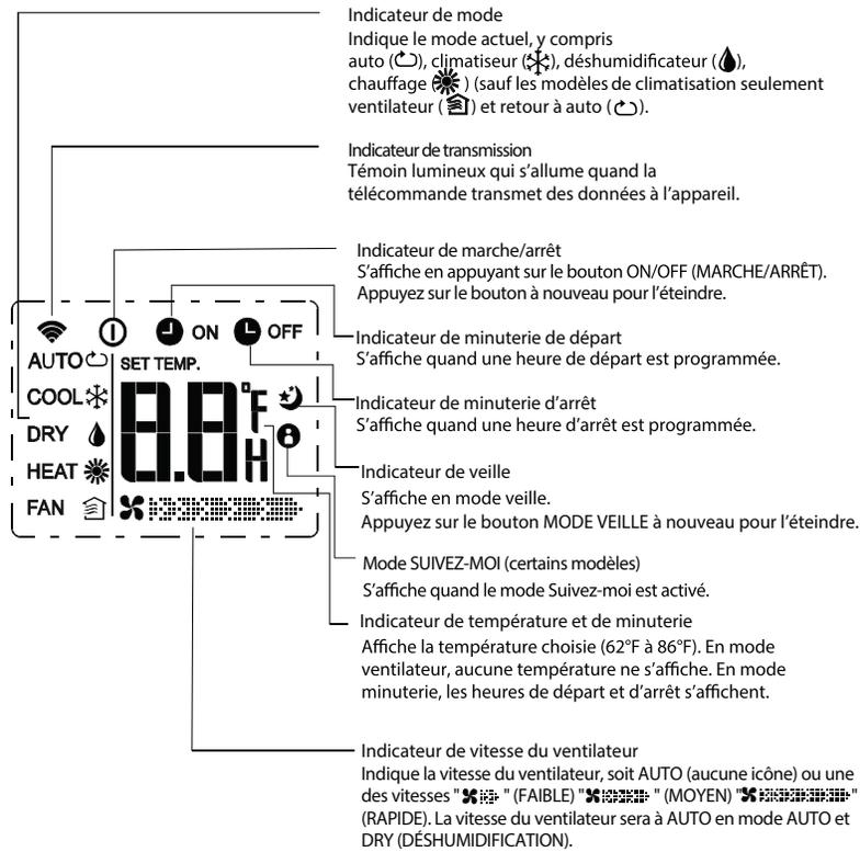
Fig. 4 - Affichage de l'appareil
